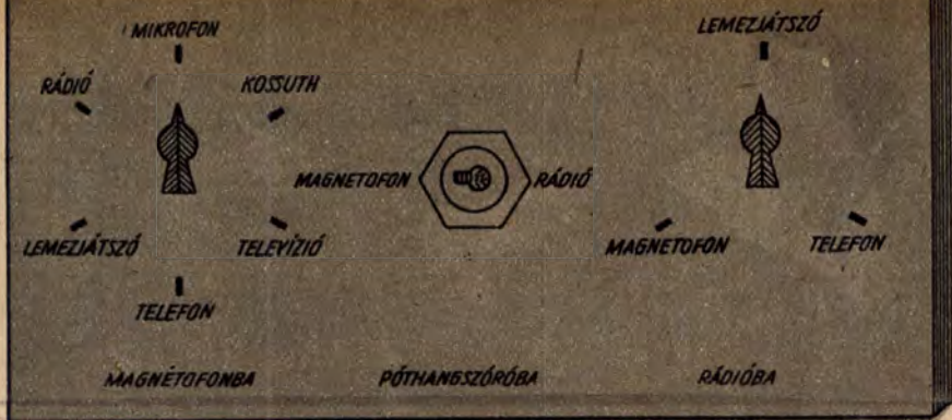
2/a. ábra. A Teleráma előlapjának elrendezési rajza
